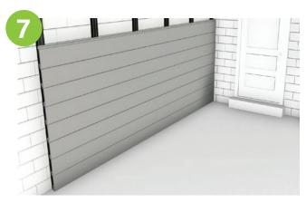
Continue a encaixar as réguas de ripado dessa forma até cobrir completamente a área desejada. É possível encaixar suas réguas lado a lado simplesmente juntando as duas pontas. Pode ser necessário instalar mais vigas se
