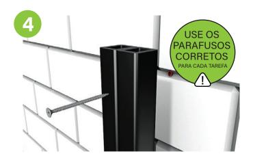
Encaixe a segunda régua de ripado na primeira régua e repita o processo de fixação, certificando-se de que a segunda régua está firmemente encaixada em cada viga de substrutura.
