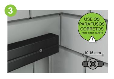
Encoste a primeira régua de ripado por cima do sarrafo. Pré-perfure 1º os orifícios do parafuso da primeira régua de ripado antes de inserir o parafuso, o comprimento do orifício é sugerido para ser 10-15 mm, deixando assim espaço suficiente para a expansão normal do ripado. Certifique-se a 1ª régua de ripado está totalmente nivelada antes de prosseguir para as réguas seguintes.
